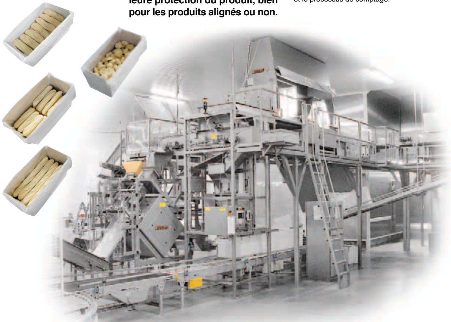
Vollautomatische Anlage mit Kamera-systemen zur Qualitätsprüfung und stückgenauen Zählung, kombiniert mit Einlegesystem AVN 1304 und der schräg gestellten Schlauchbeutelmaschine AVN E 350 D/500-45.
