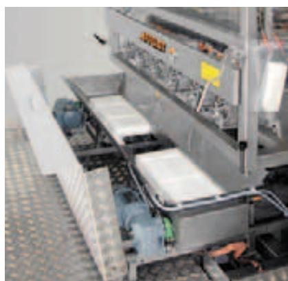
Die herausziehbaren Querbänder und die offene Bauweise ermöglichen gründliche und leichte Reinigung sowie gute Zugänglichkeit zu den Bauelementen.
